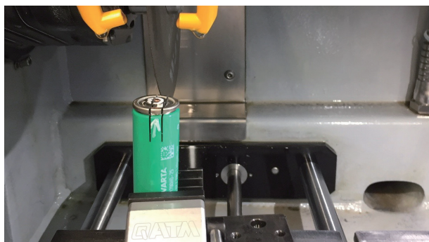
QATM 切断機による LIB 完成品の切断
