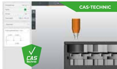
Die innovative CAS-Technologie (Collision Avoiding System) schützt die mechanischen Komponenten des Geräts durch 3D Vorausberechnung der Bewegungen im visualisierten Prüfraum vor Kollisionen und Bedienerfehlern.
