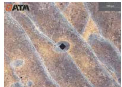
Abb. 4: Härte: 129 HV0.1, geprüft in der Mitte des Querschnitts - 10x
