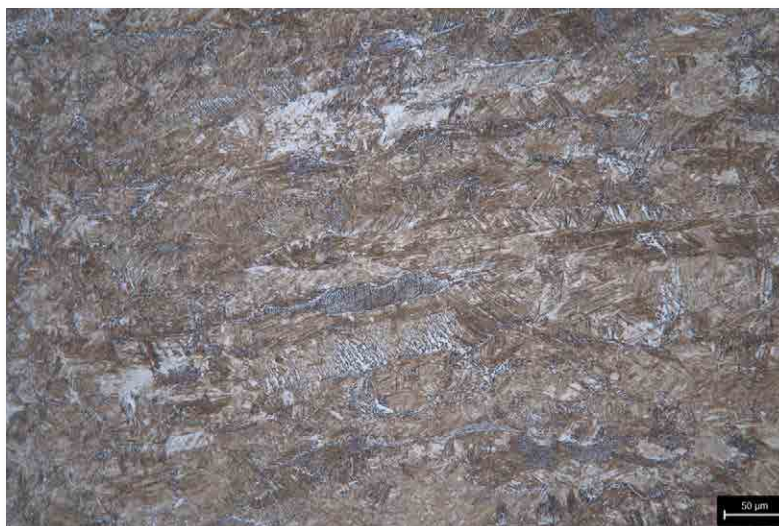
Gefüge der Schweißnaht nach dem Ätzen - 200 x
