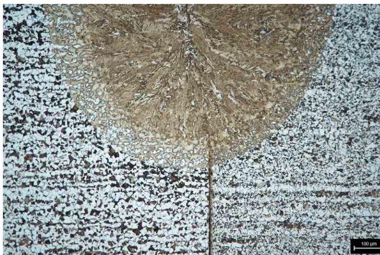
WIG-Schweißzone und Wärmeeinflusszone nach der Ätzung mit dem 3%-Salpetersäure - 100 x
