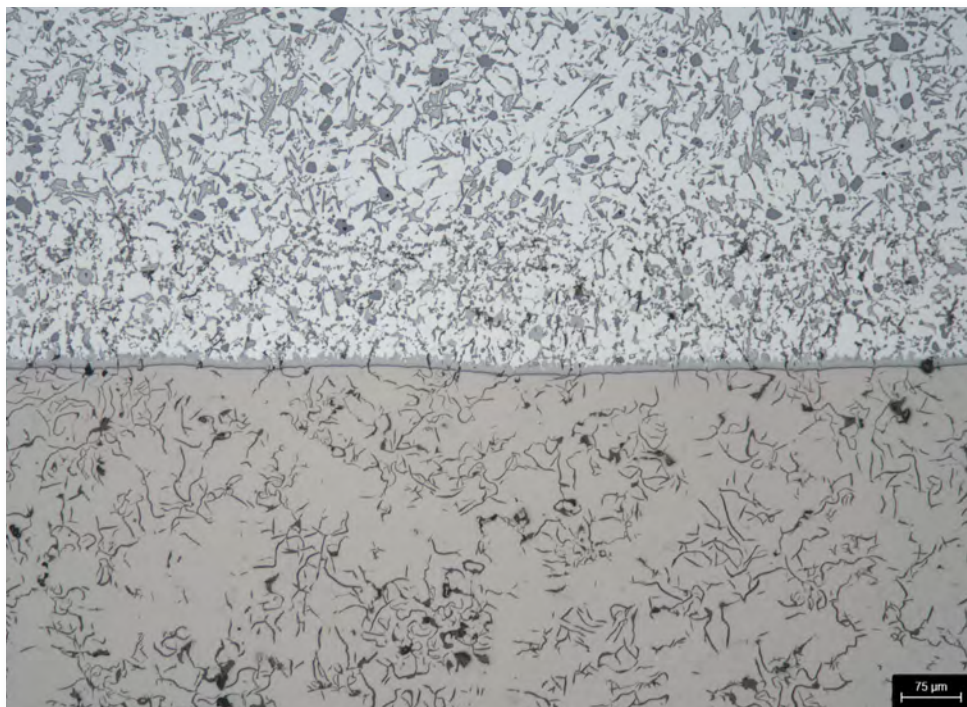
Das AlSi/Grauguss Gefüge unter dem Lichtmikroskop - 100x
