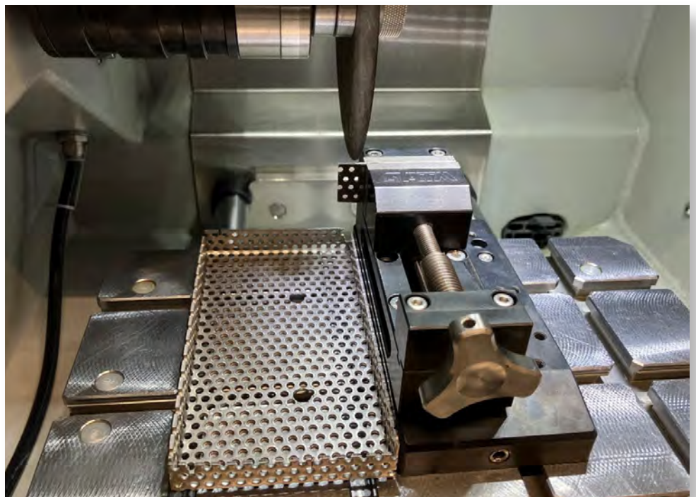
Spannmittel mit eingespannter Probe (EMPFEHLUNG 2)
