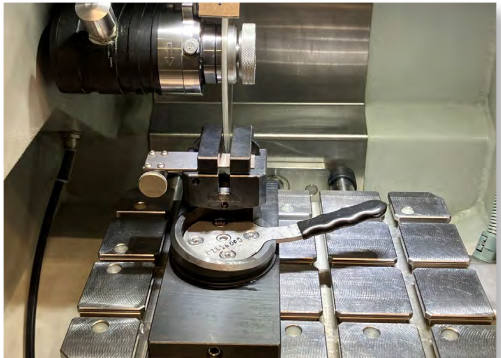
Spannmittel mit eingespannter Probe (EMPFEHLUNG 1)
