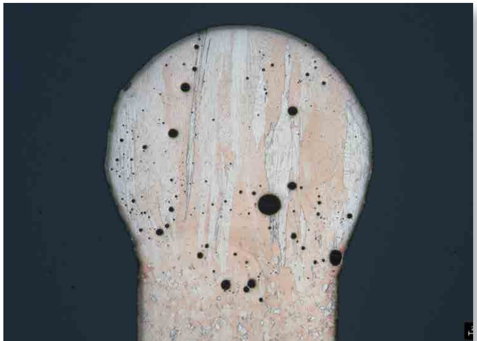
Die Schweißnaht nach Endpolieren - 25 x
