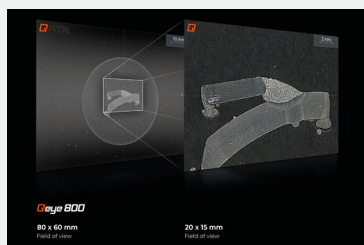
Evaluación de macrosoldaduras
