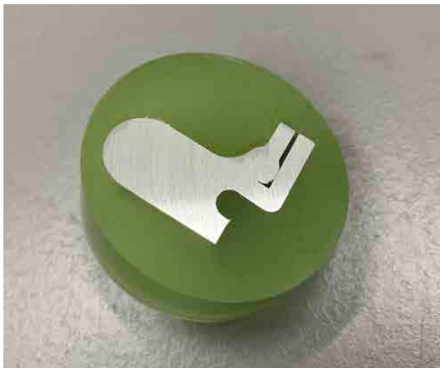
Die eingebettete Probe – Probenoberfläche, die elektrolytisch bearbeitet wird
