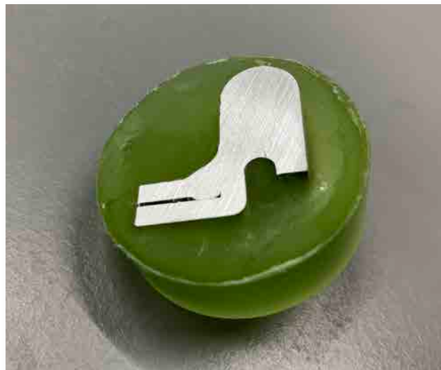
Abbildung A: Proberücken ist zum Kontaktieren frei
