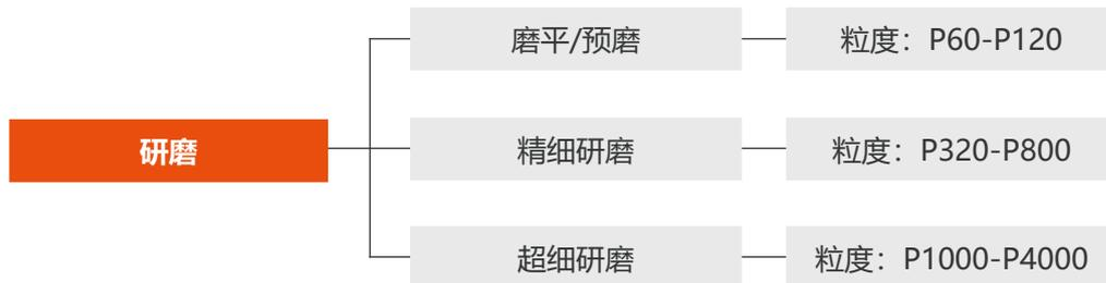
通常，碳化硅 (SiC), 氧化铝 (Al<sub>2</sub>O<sub>3</sub>), 氧化硅 (SiO<sub>2</sub>), 氧化锆 (ZrO<sub>2</sub>), 金刚石或立方氮化硼 (CBN) 被用来作为磨料。特别需注意在尽可能减少制备步骤的同时，实现低变形的材料去除。QPREP全系列研磨耗材可实现这个目的。
