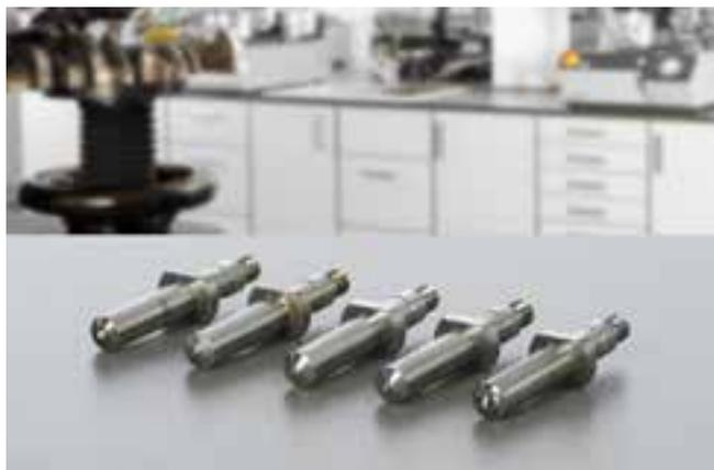
根据各自的测试方法(布氏、维氏、洛氏和努氏)选择各种压头。选择经过DAkkS和/或ASTM认证的QPREP压头, 金刚石压头和硬质合金球, QATM为硬度测试提供了广泛的测试设备组合。
