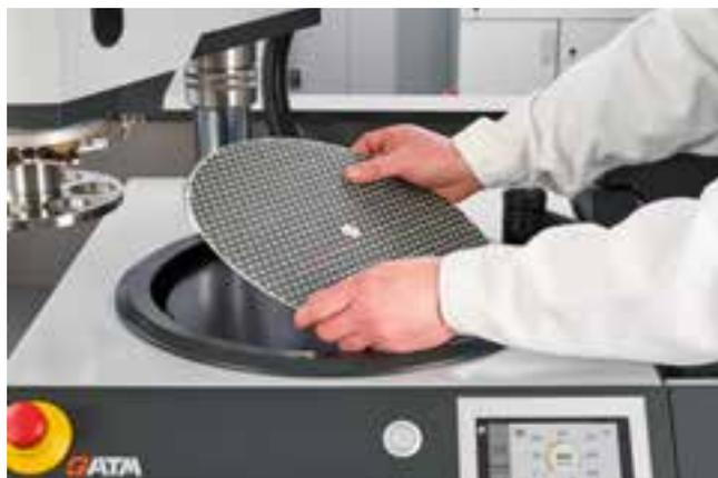
举例放置金刚石磨盘到磁性膜上
