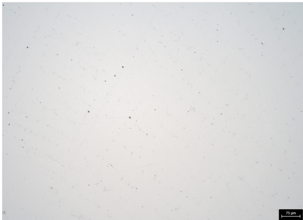
Das CoCrMo – Gusslegierungs-Gefüge unter dem Lichtmikroskop – 100 : 1 (ungeätzt)
