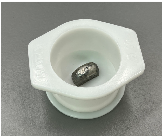
Probe in die geeignete Einbettform vorbereitet zum Einbetten
