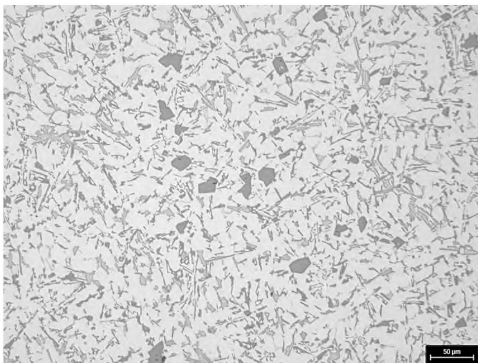
Die Al-Si Gusslegierung unter dem Lichtmikroskop – 200:1
