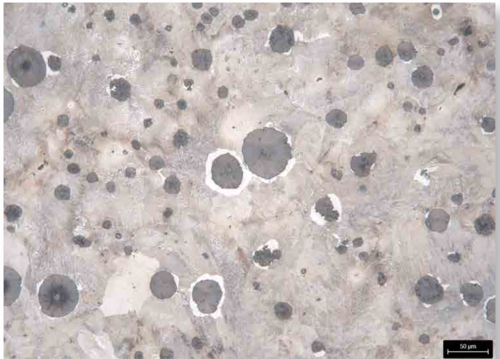
Das Gefüge nach dem Ätzen mit 3%iger alk. Salpetersäure – 100:1
