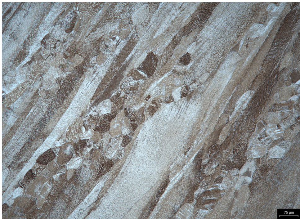
Das Gefüge der Titanlegierung unter dem Lichtmikroskop – 100:1
