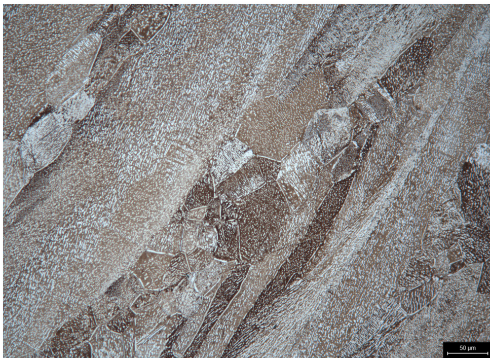
Das Gefüge der Titanlegierung unter dem Lichtmikroskop – 200:1
