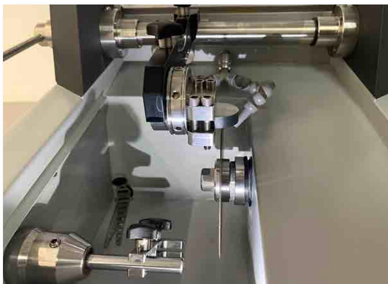
Einspannen der Proben im Trennraum der Qcut 150 A
