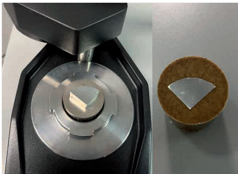
Probe im Presszylinder und nach dem Einbetten
