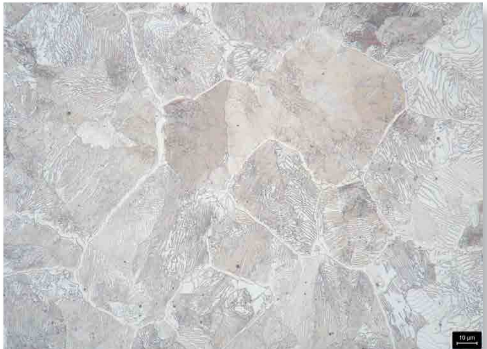
Das Gefüge mit Perlit und sekundärem Zementit nach dem Ätzen- 500:1
