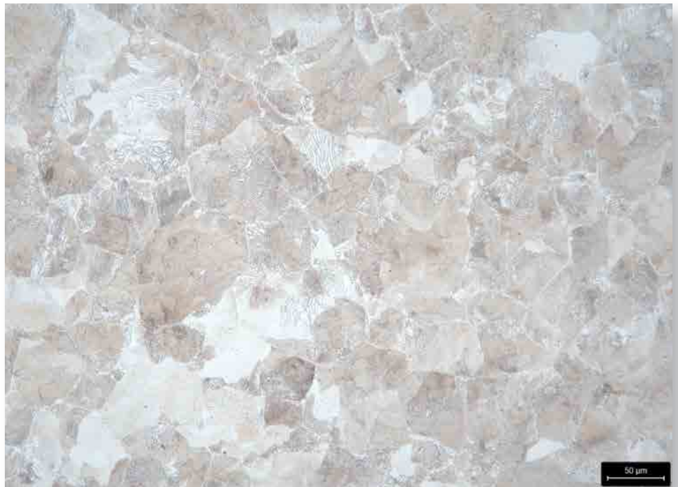
Das Gefüge mit Perlit und sekundärem Zementit nach dem Ätzen- 200:1
