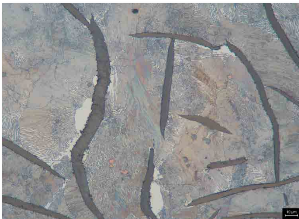
Das Gefüge des GJL nach dem Ätzen unter dem Auflichtmikroskop (500:1)
