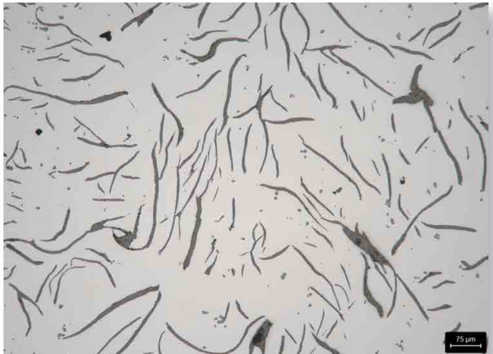
Das Gefüge des GJL nach dem 1 µm-Schritt unter dem Auflichtmikroskop (100:1)
