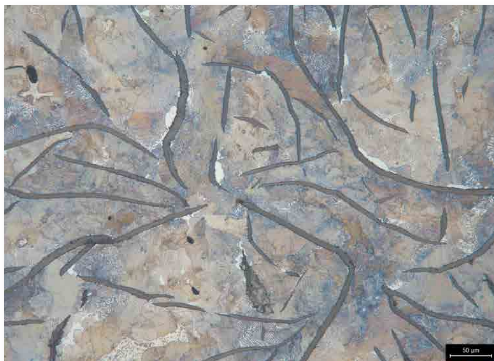
Das Gefüge des GJL nach dem Ätzen unter dem Auflichtmikroskop (200:1)
