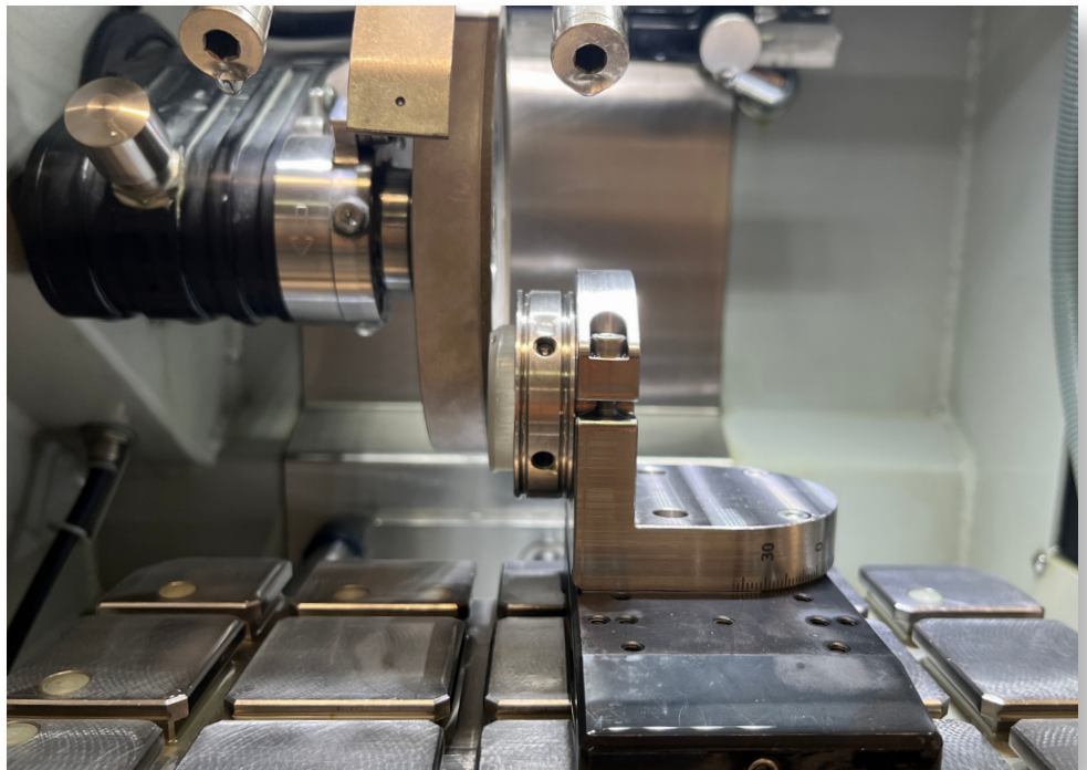
Einrichtung der Probe in die Qcut 200 A Maschine für die Zielpräparation
